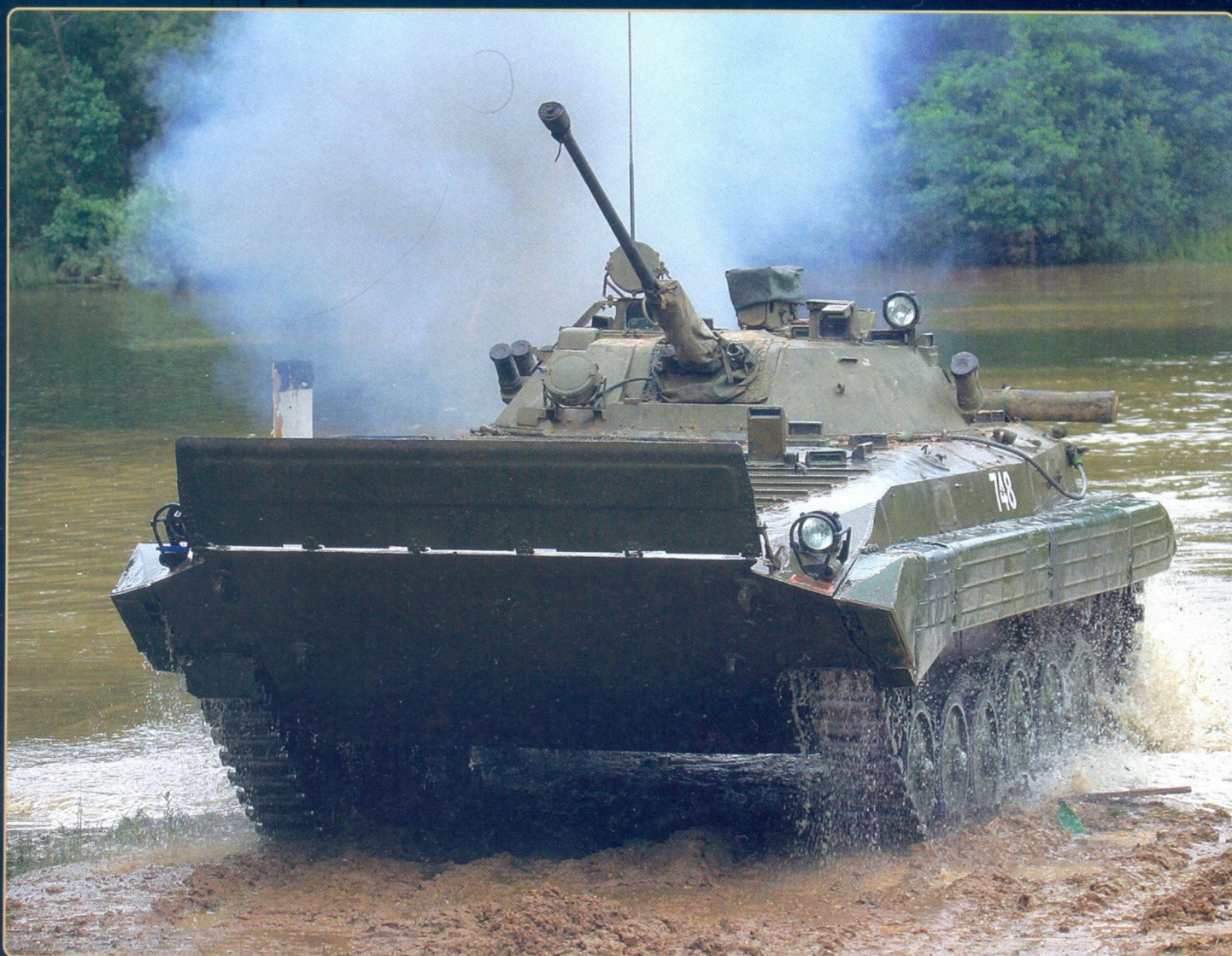
Боевая машина пехоты БМП-2 форсирует водную преграду
