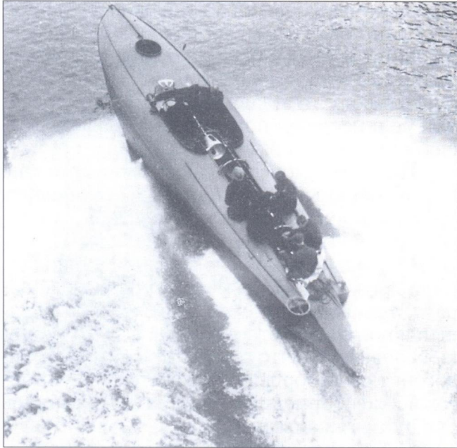
Британский катер типа СМВ-40 во время испытаний. Вес торпеды имитируют несколько человек, сидящих в желобе торпедного аппарата
