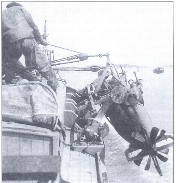
Торпеда на итальянском катере, подготовленная к пуску с помощью бугельного торпедного аппарата
