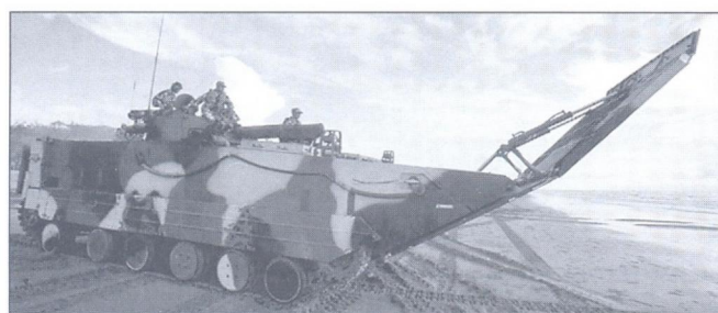
Китайская БМП раскладывает носовую глессирующую поверхность
